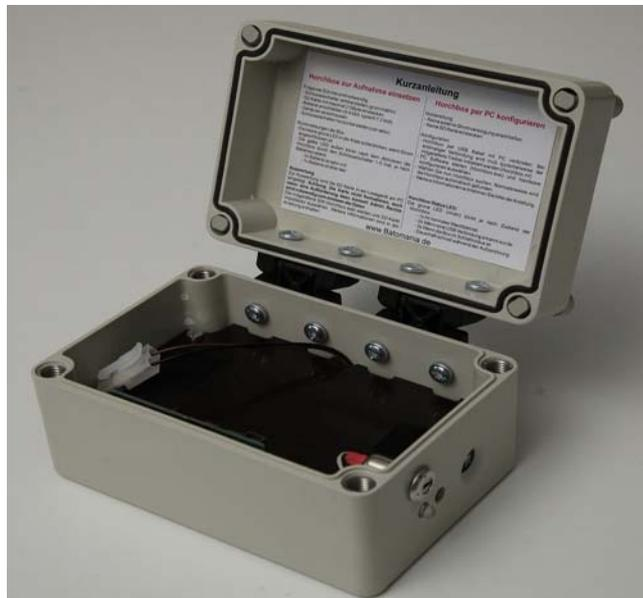
Abbildung 2.1: Horchbox (Standard- Horchbox 1.5, Batomania), bestehend aus Detektor mit SD-Karte, Akku und Außenmikrophon)
